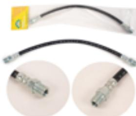
Шланг тормозной УАЗ 3163 передний средний L=400мм
